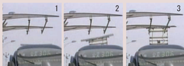
写真2 バスの屋根からパンタグラフが伸び充電 (出典：煙台市作成DVD)
